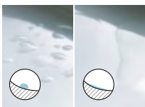
À gauche : hydrophobe À droite : hydrophile (CEFIONTECT)
